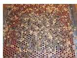
Figur 2. Efter sigtning på øverste sold. Da roepillerne er forholdsvis store, er de nemme at sortere fra efter første sigtning. Vægten af roepillerne bliver derved ret præcist bestemt.
